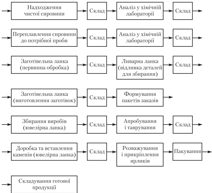
Схема 1. Технологічний процес виробництва ювелірних виробів
